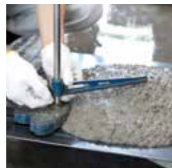
生コンを詰めてコーンを外し、落下した生コンの高さを測るスランプ試験
