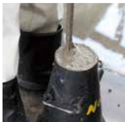
生コンを詰めてコーンを外し、落下した生コンの高さを測るスランプ試験
