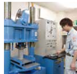
保管しているサンプルの強度を試験機で測定する
