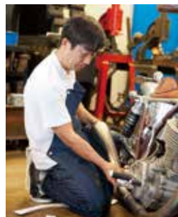
湾曲したマフラーは2枚の金属板を溶接してから水を流し込み水圧で円筒にする
