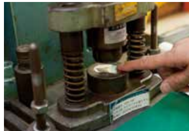
ダイヤフラムの波形をプレス加工する。金型は小俣社長自身が作った技術の結晶
