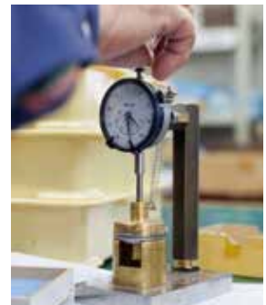
同じ圧力でスイッチが入るように一つひとつ精密に調整
