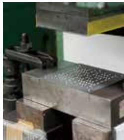
プレス機にセットされた金型。細かい穴を開ける
