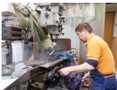
手動の機械を使って、金属を切削する感覚を身体で覚える
