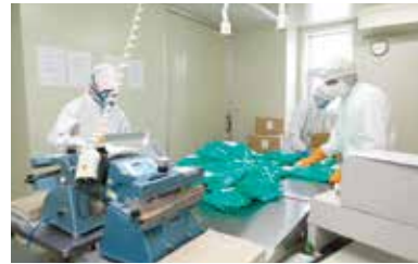
シール機で封をして（左）から、密封されているか、ピンホールはないかを全数検査（右）する
