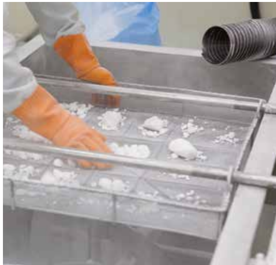
原材料をミキサーへ投入する前に、異物の混入がないか目視で厳しくチェックする。小さな異物も見逃さない
