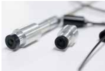
0.5ミリのイメージファイバー。先端に特殊なレンズが付いていて、どんなに曲けても画像が見える
