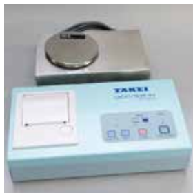
尿の出方を時間経過とともに記録する医療機器（ウロフロメーター）
