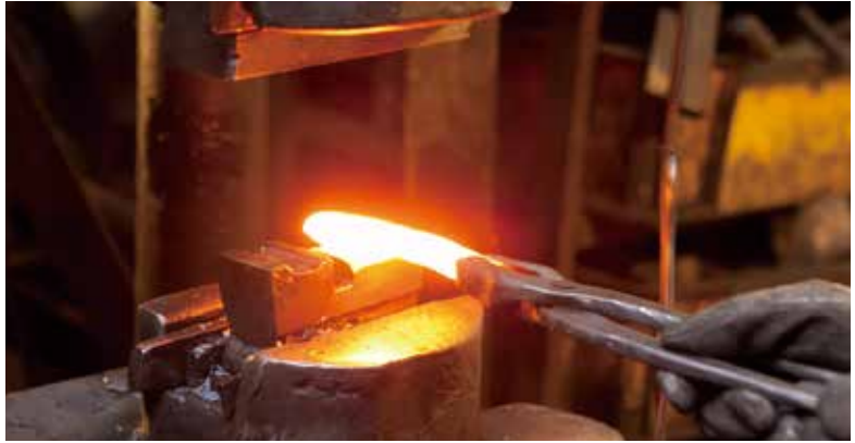
1200~1300度に熱した鉄をスプリングハンマーでたたく
