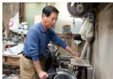
筋金を体の形に合わせて曲げる作業。患者さんから取ったトレースを元に作る
