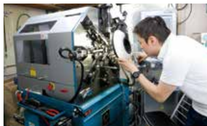
量産工場で使われるフォーミングマシンを使って、現場と同じ条件で製造できるかどうかを確認する
