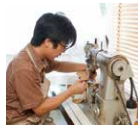
型紙に合わせて切り抜いた革を、革用マシンで縫い合わせる
