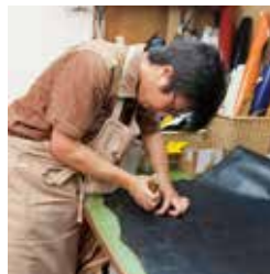
革の繊維には向きがある。伸びやすい向きを靴の幅方向に合わせる
