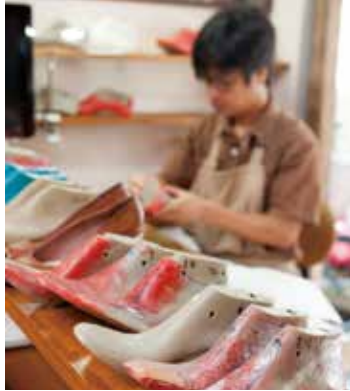
フルオーダー靴の最初のステップは一人ひとりの木型づくりから
