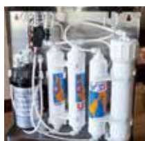
浄水器の内部。逆浸透膜および前後処理フィルターの4本構成
