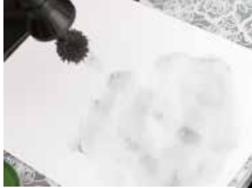
指紋検出用の磁石の刷毛。ふわっと広がるように磁力を調整するのがノウハウ
