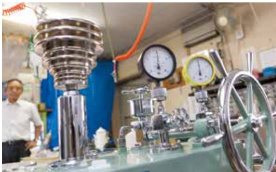
計量法に定められた圧力の基準器で正確に検査する。品質管理は極めて厳しい
