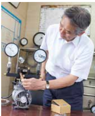
ポンプやモーターのそばに設置しても、針が振動せず正確な数値を示す振動に強い圧力計
