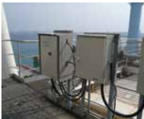
環境立国沖縄県で煙突からのばいじんを連続監視する同社のダスト濃度計
