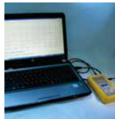
通信機能を持った放射線線量計。自宅から連続測定できる
