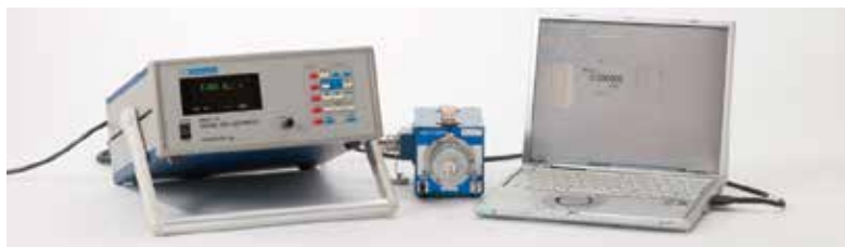
放射線計測のための微小電流計。川口電機製作所はセンサーを昌栄電機はソフトウェア、ハードウェアを開発
