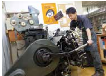
箔押しやエンボス加工の印刷機。1枚1枚でいねいに刷る佐久間さん
