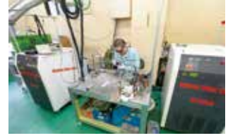
装置とファイバーケーブルでつながれたトーチからは、自由な角度でレーザー光を照射できる
