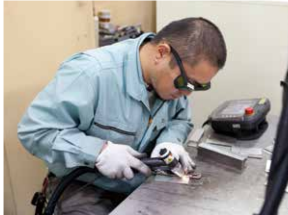
装置とファイバーケーブルでつながれたトーチからは、自由な角度でレーザー光を照射できる
